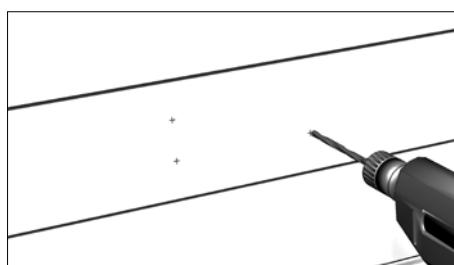
Откройте ворота и просверлите отверстие Ø15 мм в угловой стойке для входления ригеля замка.
