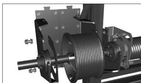
Установите пластины фиксации концевых втулок.
