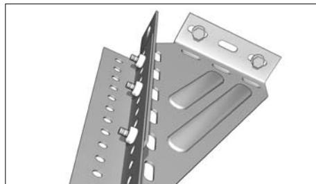
Закрепите универсальный угловой кронштейн к перфорированному углу при помощи болтов с полукруглой головкой и гаек с фланцем.
