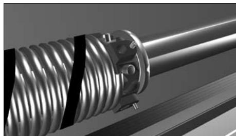
После взведения пружины зафиксируйте ее, положив упоры под монтажные воротки, задвиньте в пазы окончания стопор, вытащите вороток. Затяните шестигранные винты крепления окончания пружины к валу.
