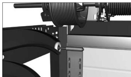
Установите ролик опоры в верхнюю горизонтальную направляющую. Ослабьте саморезы, отрегулируйте верхние опоры таким образом, чтобы обеспечить плотное прилегание верхней панели к притолоке. Затяните саморезы.
