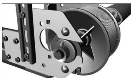
При помощи 2-х болтов с полукруглой головкой (M8×16) пластину концевую с подшипником закрепите к концевому опорному кронштейну для барабана сзади, болты зафиксируйте на ближних к притолоке или дальних от притолок пазах (относительно проема) в зависимости от установленных барабанов.
