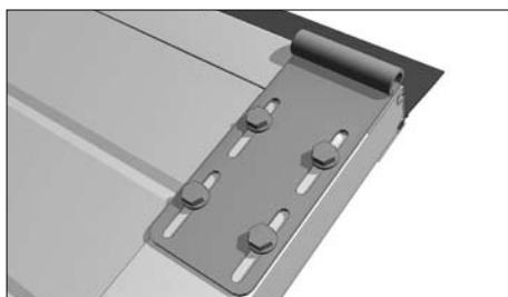
При сборке верхней панели установите верхние опоры ролика. Выровняйте края углового кронштейна по панели, просверлите 4 отверстия 4,2 мм и закрепите его при помощи саморезов для панелей ворот.
