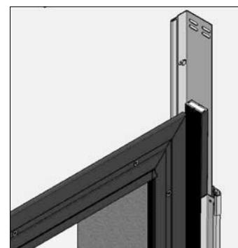
Закрепите уплотнитель по контуру проема с помощью саморезов из комплекта ворот как показано на рисунке.
