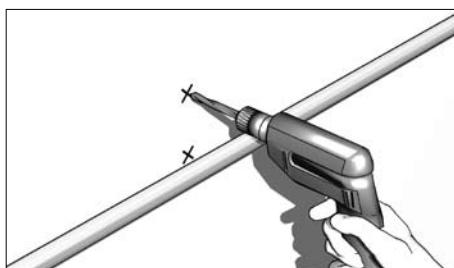
Закрепите механизм защиты от обрыва пружины к стене проема при помощи саморезов с шайбами.
