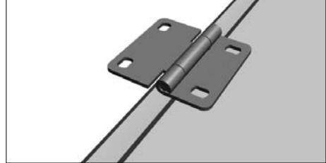
Установите внутренние петли по отверстиям в панели, ранее сделанным на производстве. Отверстия в нижней части петли должны совпадать с отверстиями в панели, сделанными на производстве.
