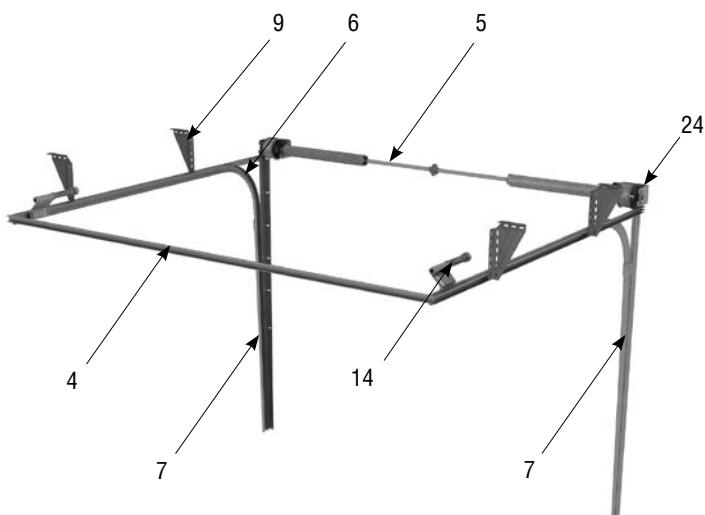
Система направляющих и тормозных механизмов
