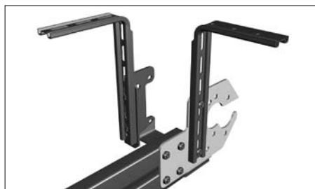
На концевой опорный кронштейн для барабана сзади и на кронштейн крепления устройства безопасности для барабана сзади закрепите на болты с гайками универсальные кронштейны.
