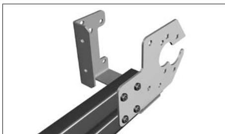
Установите на обе горизонтальные направляющие, соединенную конструкцию крепления кронштейна концевого опорного для барабана сзади и кронштейна крепления устройства безопасности для барабана сзади. Закрепите собранный кронштейн к двойным горизонтальным направляющим при помощи болтов 8×16 с полукруглой головкой, затяните их гайками
