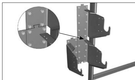
Приставьте выносной кронштейн для второго вала вплотную к стене таким образом, чтобы пазы верхнего и нижнего кронштейна совпали.
