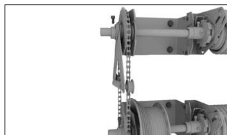
На верхний вал установите натяжитель цепи. Зафиксируйте положение натяжителя цепи стопорным кольцом.
