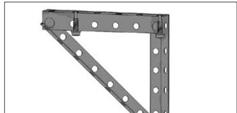
Монтажные уголки собираются из перфорированного уголка 32×32 мм с учетом расстояния от горизонтальных направляющих до потолка.
