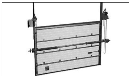
При помощи ручной цепи поднимите торсионный механизм до выносных кронштейнов.
