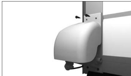
Установите кожух на устройство безопасности. Зафиксируйте его при помощи 2-х саморезов, предварительно снятых с устройства от обрыва троса. Аналогично установите второй кожух.
