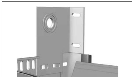
Установите опорный кронштейн вплотную к стене и угловой стойке, совместив при этом отверстия в опорном кронштейне, угловой стойке и кронштейне для крепления шкива.
