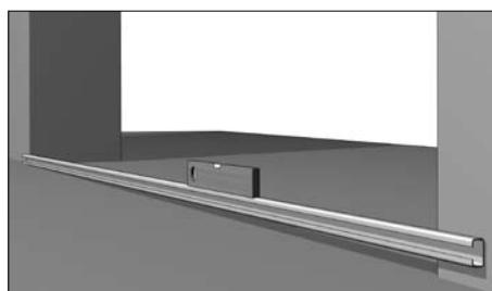
Перед установкой вертикальных направляющих необходимо проверить горизонтальность пола. Для чего положите С-профиль на пол и проверьте его горизонтальность с помощью строительного уровня.
