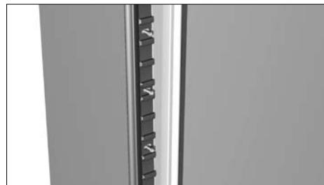
Установите накладки по отверстиям в угловой стойке и закрепите их одновременно со стойкой к стене проема с помощью саморезов с шайбами.
