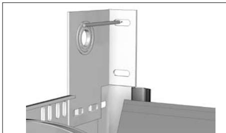
Разметьте и просверлите отверстия сверлом Ø12 мм для крепления к стене проема по перфорации в опорном кронштейне.
