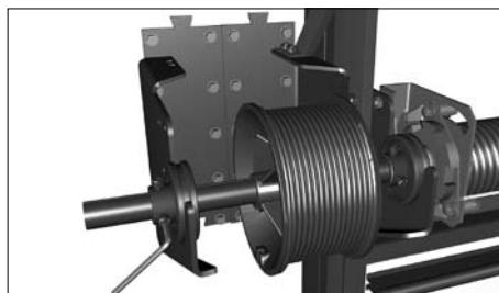
Зафиксируйте устройство от обрыва пружины. Затяните винты на концевых втулках.
