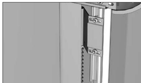
Закрепите амортизатор к С-профилю, на вертикальной направляющей согласно рисунку. Установите амортизатор таким образом, чтобы при открытых воротах он находился в сжатом состоянии не менее 50% от длины его хода. Аналогично установите амортизатор на второй направляющей.
