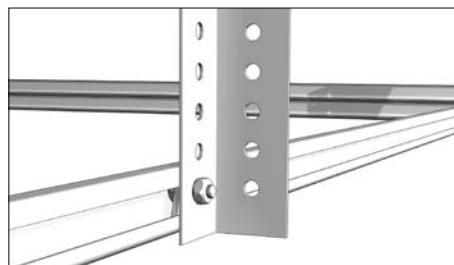
Б) При высоте притолоки больше 400 мм направляющие крепятся при помощи универсальных угловых кронштейнов, перфорированного уголка, соединителей перфорированного уголка и двойных направляющих и болтов с гайками.
