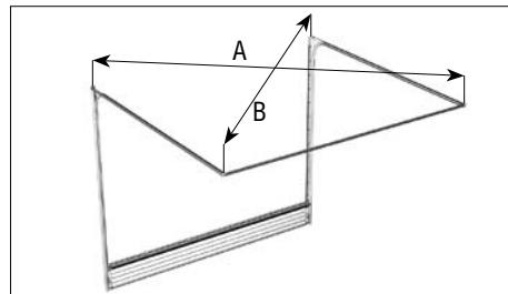
Проверьте горизонтальность направляющих с помощью строительного уровня (при необходимости отрегулируйте). Перед окончательным креплением направляющих к потолку необходимо проверить расстояние между противоположными углами (диагонали А и В должны быть одинаковы).
