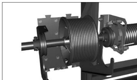
Установите торсионный механизм в пазы выносных кронштейнов позиционируя концевые втулки.
