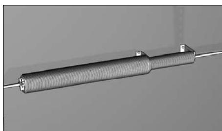
Просверлите намеченные отверстия. Закрепите кронштейны при помощи дюбелей и саморезов с шайбами. Прикрепите окончания пружины Ø95 мм к опорному кронштейну при помощи болтов M10×45 с гайками, окончание пружины Ø152 мм закрепите болтом 3/8"×11/2".
