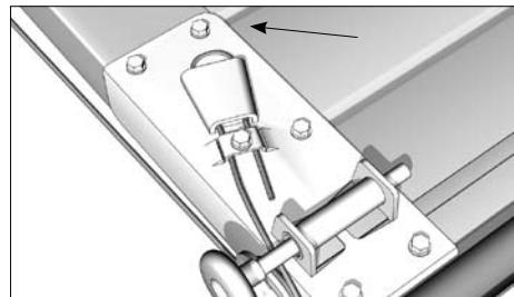
Закрепите устройство от обрыва пружины к концевому опорному П-образному кронштейну при помощи двух комплектов крепежных элементов (болт 10×25, гайка M10, шайба 10 гроверная).
