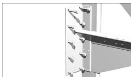
Закрепите кронштейн к стене при помощи дюбелей с саморезами и к угловой стойке при помощи болтовых соединений. Аналогично установите второй кронштейн с другой стороны проема.
