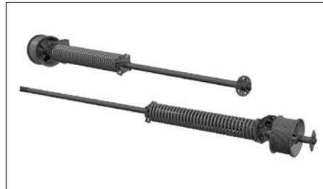
Направление закрутки пружин должно совпадать с направлением ее навивки. Т. е. для правой пружины направление закрутки должно осуществляться против часовой стрелки, а для левой — по часовой стрелке.
