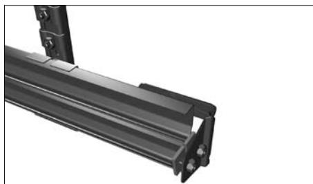
На кронштейн угловой соединительный закрепите 2 закладные пластины болтами 8×25 мм с полукруглыми головками с гайками.
