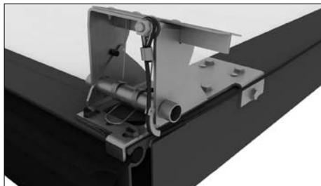
При использовании углового кронштейна с устройством защиты от обрыва троса разметьте и просверлите 6 отверстий 4,2 мм для крепления кронштейна. Закрепите его при помощи 6 саморезов 6,3x38 мм.
