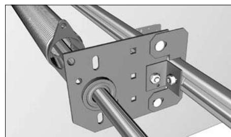
Установите вал в подшипники концевых опорных кронштейнов, предварительно установив на него барабаны, пружину и кронштейн крепления для барабана сзади.
