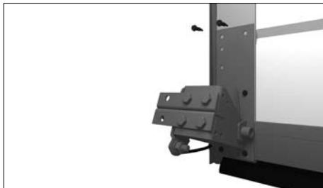
Открутите два верхних самореза на устройстве от обрыва троса.
