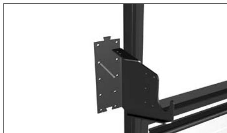
Прислоните выносной кронштейн для низкого вала к стене проема вплотную к угловой стойке (с внешней стороны) согласно монтажной карте. По перфорации в кронштейне сделайте разметку для его крепления к стене.
