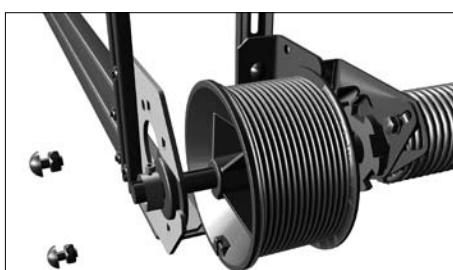
Установите на П-образные кронштейны торсионный механизм в сборе. При помощи 2-х болтов с полукруглой головкой (M8×16) пластину концевую с подшипником закрепите к концевому опорному П-образному кронштейну. Закрепите устройство от обрыва пружины к концевому опорному П-образному кронштейну при помощи двух комплектов крепежных элементов (болт 10×25, гайка M10, шайба 10 гроверная).
