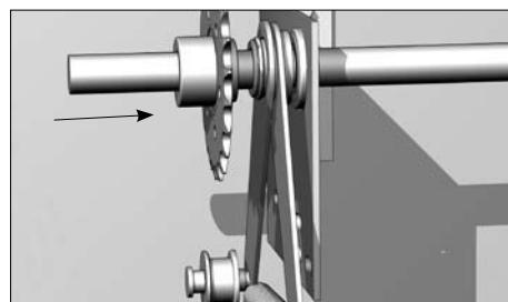
Установите звездочку вместе с цепью вплотную к устройству натяжения цепи.
