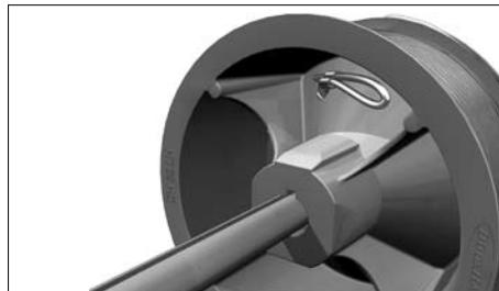
Разрежьте трос на две равные части. Пропустите свободный, не обжатый втулкой, конец троса через просверленное отверстие в барабане, протяните его вдоль направляющих и выведите к нижнему угловому кронштейну. Установите барабан к опорному кронштейну, намотайте на него трос на то количество витков, которое указано в монтажной карте. Закрепите барабан на вале крепежными болтами.
