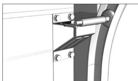
Установите верхнюю панель. Отрегулируйте положение верхнего ролика, обеспечив плотное прилегание панели к проему.
