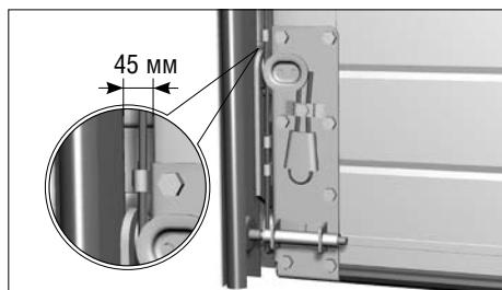
Устройство безопасности троса устанавливается на полотно ворот по аналогии с нижним угловым кронштейном с тонкой регулировкой троса (с клиновидным креплением). При установке углового кронштейна с устройством безопасности троса заведите трос в клиновидный карман на кронштейне согласно рисунку. Пропустите трос в хомут на крюке кронштейна, поместите клин в петлю троса, затяните трос вместе с клином в клиновидный карман.
