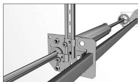
Закрепите пружину к кронштейну крепления для барабана сзади двумя болтами с гайками.
