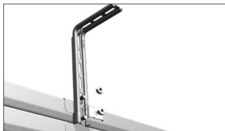
А) При высоте притолоки до 400 мм направляющие крепятся при помощи четырех угловых кронштейнов, скоб и болтов с гайками. Закрепите универсальный кронштейн на двойные направляющие с помощью скобы и болта с гайкой.
