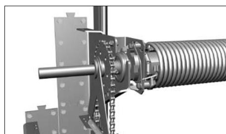
Установите натяжитель цепи на верхний вал и зафиксируйте его стопорным кольцом.
