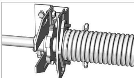
Закрепите фланец пружины к рычагу защелки двумя болтами с гайками.
