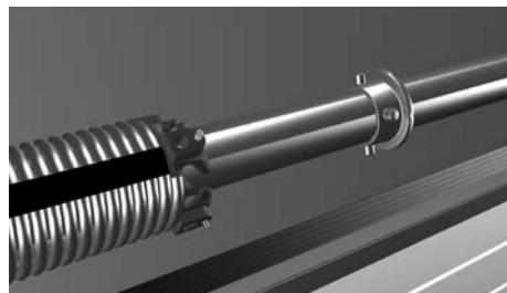
На пружине проведена краской специальная разметочная полоса, служащая для указания количества закрученных витков пружины.
