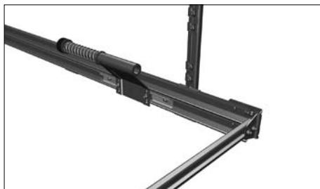
Закрепите пружинный амортизатор с помощью закладных пластин и болтов с гайками. Отрегулируйте положение амортизатора и затяните гайки.
