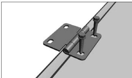
Закрепите петли при помощи саморезов для панелей ворот.
