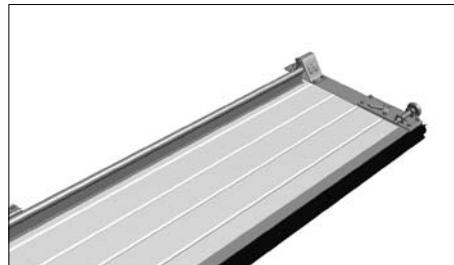
Омега-профиль устанавливается на проемах с шириной щита > 4500 мм и в случаях повышенной ветровой нагрузки. Профиль служит для усиления жесткости щита, как в вертикальном, так и в горизонтальном положении.
