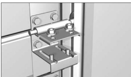
На боковые опоры установите роликодержатели с роликами.
