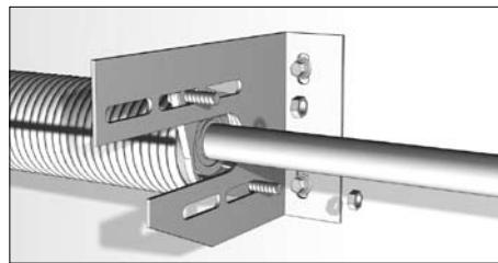
Поднимите собранный узел и установите в подшипники опорных кронштейнов. Отметьте отверстия для крепления универсального внутреннего кронштейна к стене.
