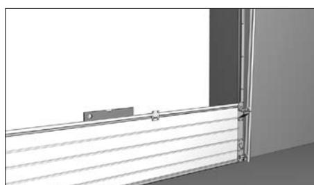
Затем по панели установите вертикальные направляющие. Расстояние от торцевой поверхности панели до кромок направляющих должно составлять около 25–30 мм.
