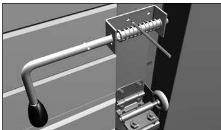
Установите задвижку на высоте, удобной для открывания. Размерьте отверстия для крепления.
