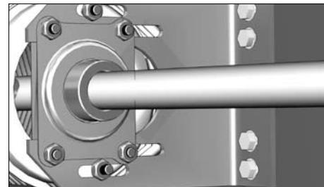
Закрепите концевой опорный кронштейн к стене проема при помощи четырех саморезов с шайбами и дюбелей. В зависимости от типа барабана расположите и закрепите регулируемый подшипник по отверстиям в кронштейне. Аналогично закрепите второй опорный кронштейн.
