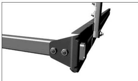
Состыкуйте С-профиль, выровняв его торцом по задней поверхности двойных направляющих, пропустите его через закладные пластины и отверстия в кронштейне угловом соединительном, затяните.
