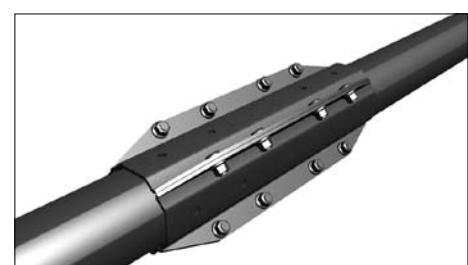
Установите соединительную муфту на двух частях вала и закрепите муфту по технологическим отверстиям с помощью саморезов по металлу 6,3×25 к октагональному валу.
