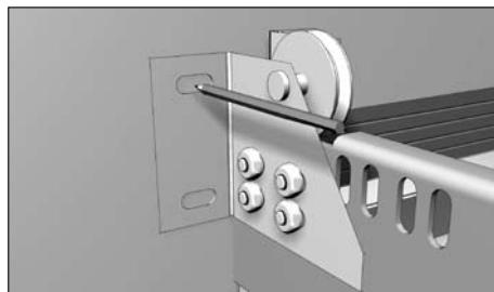
Разметьте и просверлите отверстия Ø8 мм в стене притолоки.
