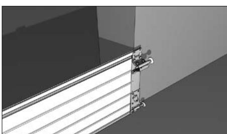
Перед установкой направляющих необходимо установить в проем нижнюю панель таким образом, чтобы ее края заходили за проем равномерно с двух сторон.
