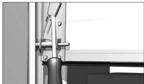
Приподнимите полотно ворот на ~150 мм и подложите деревянные бруски под углы полотна. Верхний плоскости брусков должны быть на одном уровне относительно друг друга. Опустите полотно ворот до момента касания его нижнего угла деревянного бруска. Второй угол останется приподнятым над бруском.
