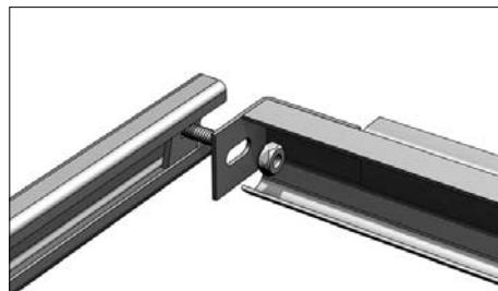
Закрепите С-профиль к концам горизонтальных направляющих с помощью закладных пластин и болтов с гайками.
