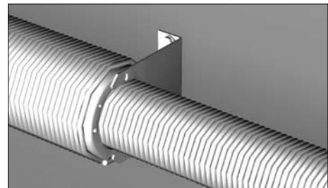
Разметьте места для его крепления к стене проема.
