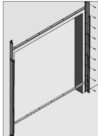
Стыки противопожарных панелей имеют Г-образную форму для хорошей устойчивости при возгорании. Панели закрепляются согласно схеме.
