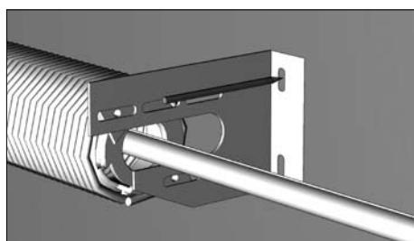
Закрепите торсионный механизм на валу прижимными винтами. Установите универсальный внутренний кронштейн для крепления окончания пружины 95 мм и разметьте места для его крепления.
