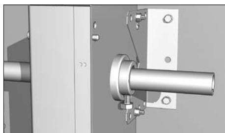
Вставьте дюбель и закрепите кронштейн крепления ручного цепного привода к стене при помощи саморезов и к приводу при помощи шайб с гайками.
