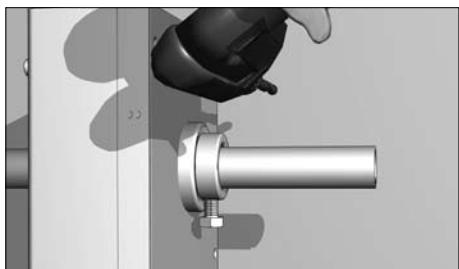
Просверлите размеченные отверстия сверлом Ø12 мм.
