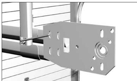
Приставьте концевой опорный кронштейн к горизонтальным направляющим с наружной стороны. По перфорации в кронштейне разметьте отверстия в направляющих для его крепления.
