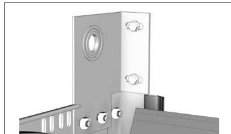
Закрепите кронштейн к стене при помощи дюбелей и саморезов с шайбами и при помощи болтов с гайками к кронштейну крепления шкива и угловой стойке.
