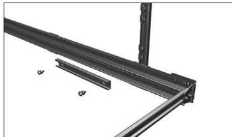
Закрепите С-профиль с помощью болтов с полукруглой шляпкой M8×25 и гаек с фланцем.
