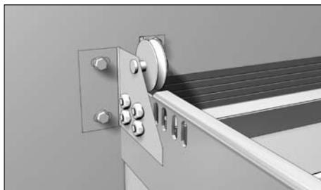
По отверстиям в угловой стойке установите шкив и зафиксируйте при помощи 4 болтов с полукруглой головкой M8×16.
