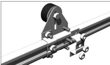
Буферы служат для ограничения хода полотна ворот при их открытии. Перед установкой буферов отверните болты с гайками и закрепите крепежные скобы с закладными пластинами на С-профиле с помощью болтов. Установите буфера симметрично относительно оси проема.
