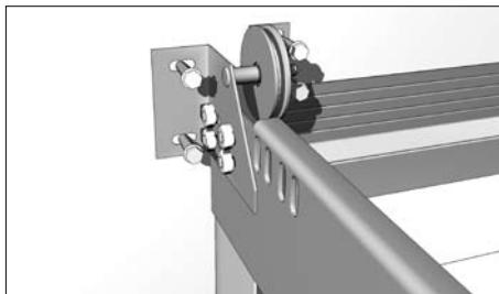
Вставьте дюбели и закрепите кронштейн шкива концевой к стене при помощи саморезов с шайбами.
