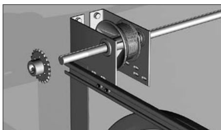
Установите на вал звездочку, предварительно вставив шпонку в шпоночный паз. Зафиксируйте звездочку на валу крепежными болтами M8×25 мм. Аналогично закрепите звездочку на валу с другой стороны проема.
