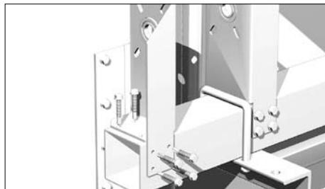
Установите внутренние выносные кронштейны для крепления барабанов на трубе согласно размерам, указанным в монтажной карте, и закрепите их с помощью саморезов по металлу.
