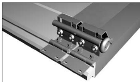
Двойные (усиленные) боковые опоры роликов используются в случае больших габаритов полотна ворот, когда нагрузка на один ролик превышает 35 кг.
