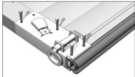
Установите нижние угловые кронштейны на нижнюю панель. Разметьте и просверлите отверстия Ø4,2 мм для его крепления. Закрепите кронштейн 4-я саморезами 6,3×38 мм (как показано на рисунке).
