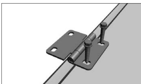
Закрепите петли при помощи 2-х саморезов.
