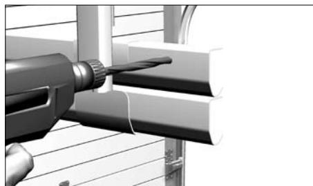
Просверлите намеченные отверстия сверлом 8,5 мм.
