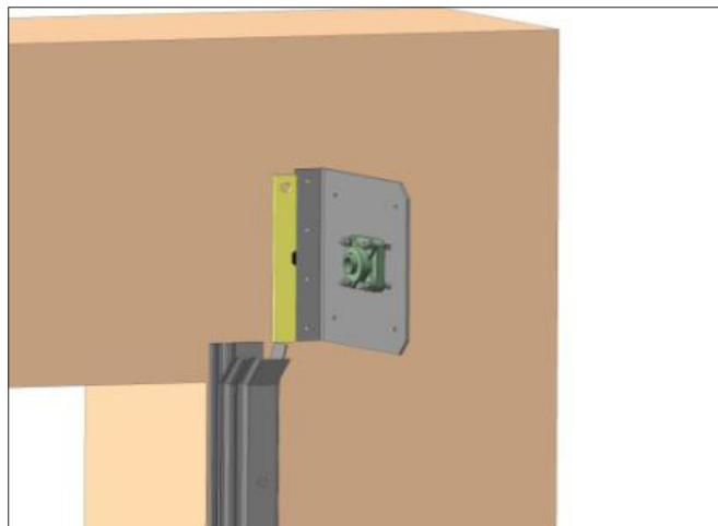
Установите суппорт с подшипником на консольный кронштейн с помощью крепежных элементов. Суппорт с подшипником необходимо устанавливать на кронштейн с противоположной стороны от места установки электродвигателя (если привод устанавливается слева, то берем правый кронштейн).
