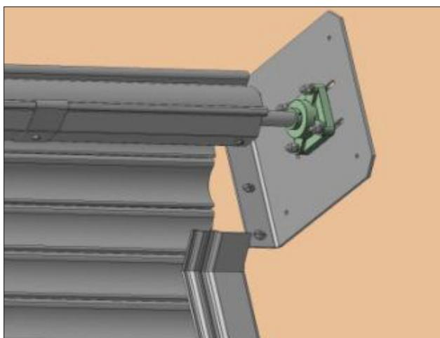
Установите (закрепите) капсулу в суппорт подшипника. Ножку капсулы выставить согласно монтажной схеме. Закрепите капсулу саморезами по металлу, просверлив отверстие через вал и капсулу. **После монтажа проверьте крепление саморезами капсулы к валу!**
