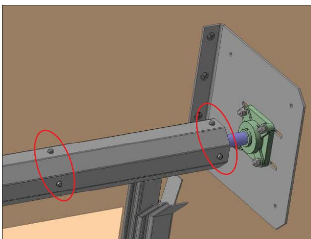
Установите (зафиксируйте) капсулу в суппорт подшипника. Ножку капсулы выставьте согласно монтажной схеме. Зафиксируйте капсулу саморезами по металлу, просверлив отверстие через вал и капсулу. **После монтажа, проверьте крепление саморезами капсулы к валу!**
