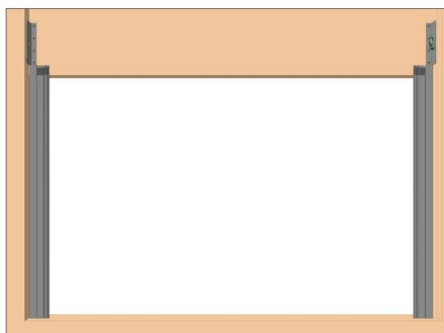
Отметьте карандашом отверстия на направляющем профиле для его крепления к стене. Снимите направляющий профиль и просверлите монтажные отверстия под установку в зависимости от используемых крепежных элементов. Закрепите направляющий профиль.
