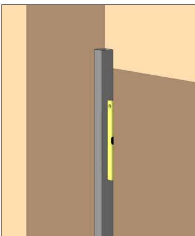
Выравнивание: выставьте балку вертикально с помощью строительного уровня длиной не менее 1,5 м. Отметьте карандашом отверстия на балке для ее крепления к стене. Снимите балку и просверлите монтажные отверстия под установку в зависимости от используемых крепежных элементов. Закрепите балку.
