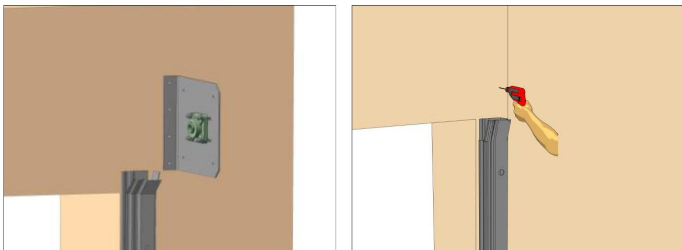
Отметьте карандашом отверстия на консольном кронштейне для его крепления к стене. Снимите консольный кронштейн и просверлите монтажные отверстия для установки в зависимости от используемых крепежных элементов.
