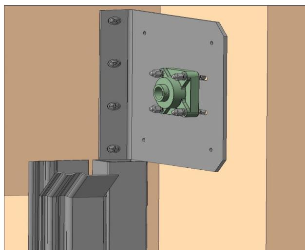
Отметьте карандашом отверстия на направляющем профиле для его крепления к стене. Снимите направляющий профиль и просверлите монтажные отверстия под установку в зависимости от используемых крепежных элементов. Закрепите направляющий профиль.
