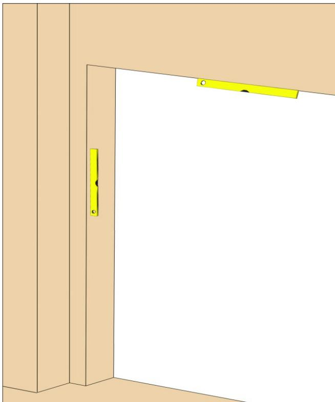
Проверьте качество обрамления проема с помощью строительного уровня длиной 1,5 м.
