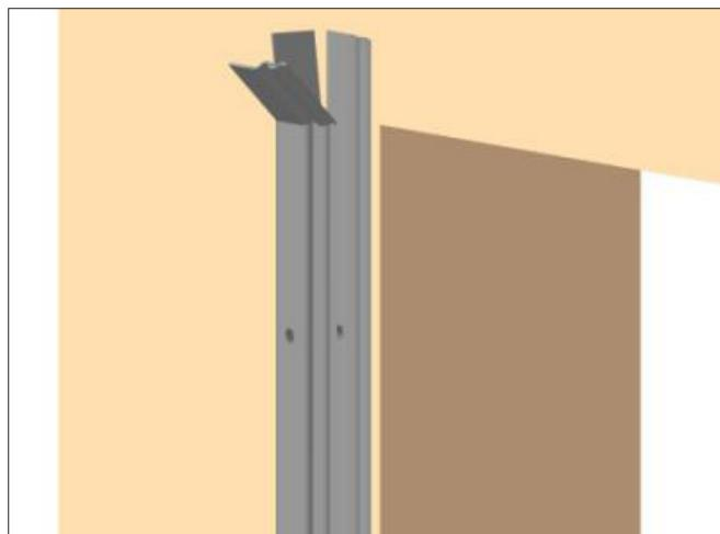
Проверьте качество обрамления проема с помощью строительного уровня длиной 1,5 м.
