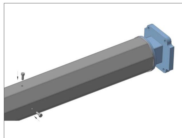
Вставьте двигатель в вал. Просверлите 4 отверстия в вале и внутреннем адаптере. Зафиксируйте привод с помощью крепежных элементов, входящих в комплект привода.
