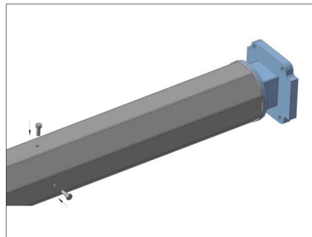
Вставьте двигатель в вал. Просверлите 4 отверстия в вале и внутреннем адаптере. Закрепите привод с помощью крепежных элементов, входящих в комплект привода.
