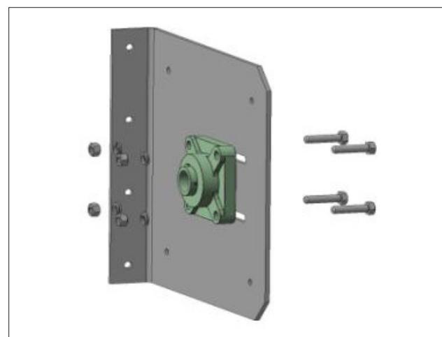
Установите суппорт с подшипником на консольный кронштейн с помощью крепежей. Суппорт с подшипником необходимо устанавливать на кронштейн с противоположной стороны от места установки электродвигателя (если привод устанавливается слева, то берем правый кронштейн).
