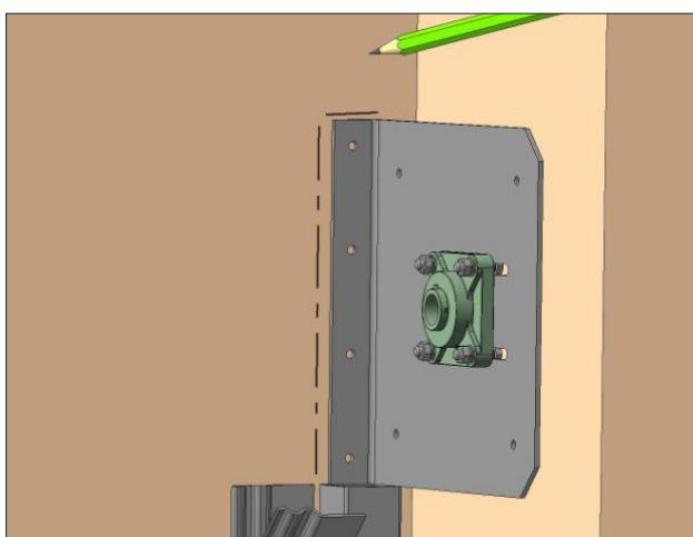
Приложите собранный консольный кронштейн с суппортом к стене согласно монтажной схеме. Выставьте вертикальность с помощью строительного уровня.
