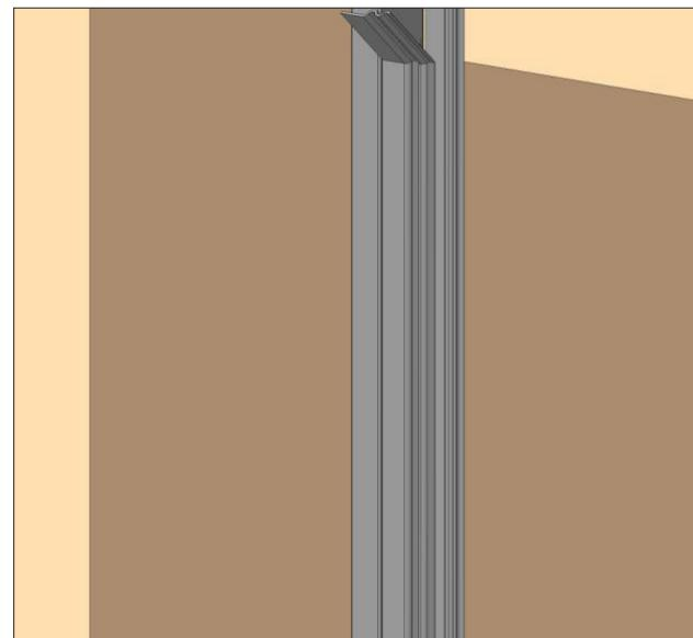
Отметьте карандашом отверстия на направляющем профиле для его крепления к стене. Снимите направляющий профиль и просверлите монтажные отверстия под установку в зависимости от используемых крепежных элементов. Закрепите направляющий профиль.
