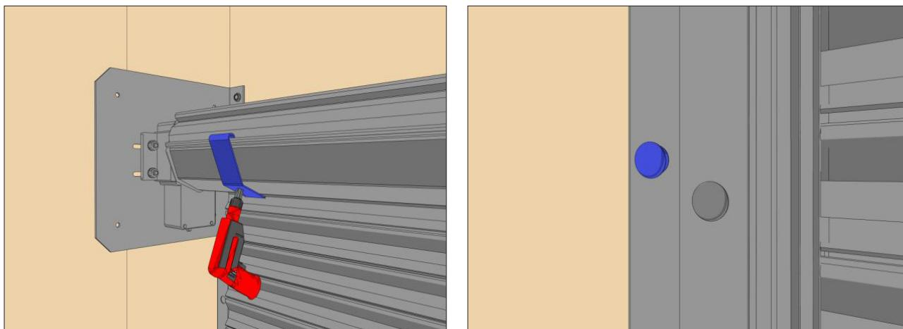
Вставьте монтажные пластины в замковую часть верхнего профиля полотна рулонных ворот. Закрепите пластины к валу саморезами по металлу. Обратите внимание, что в месте установки привода крепление монтажных пластин осуществляется «короткими» саморезами. Не просверлите электропривод!
