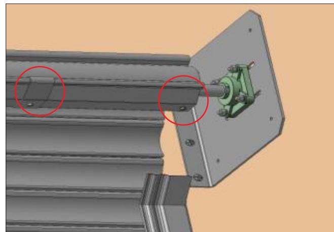
Вставьте монтажные пластины в замковую часть верхнего профиля полотна рулонных ворот. Закрепите пластины к валу саморезами по металлу. Зафиксируйте с помощью саморезов по металлу подвижную и неподвижную части регулируемой капсулы. Обратите внимание, что в месте установки привода крепление монтажных пластин осуществляется короткими саморезами.
